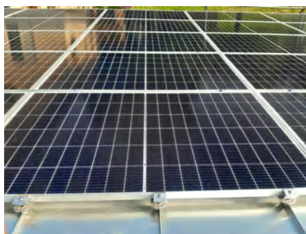
Instalación en paralelo al techo en ángulo recto con la junta con el PV-Kit 2.0 MidGrab y E-Mini en techos de doble junta de pie: puede utilizarse como pinza final y media.
